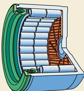
метра, что обеспечивает высокую грузоподъемность этих подшипниковых узлов без увеличения размера.
