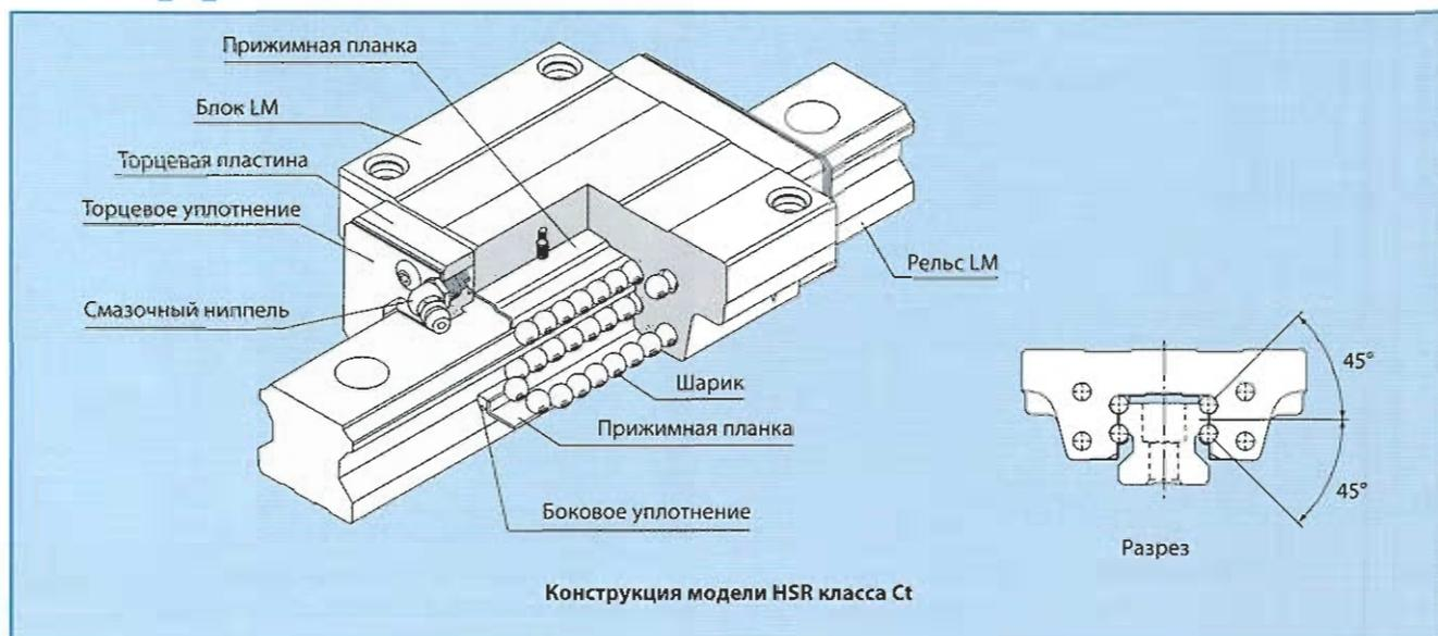
Четырехнаправленная модель с равномерной нагрузкой и размерами, соответствующими мировым стандартам, что обеспечивает простоту конструкции
