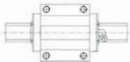
Фланец блока LM имеет резьбовые отверстия. Монтаж может выполняться как сверху, так и снизу. Это удобно, когда в опоре отсутствуют сквозные отверстия для установки болтов.
