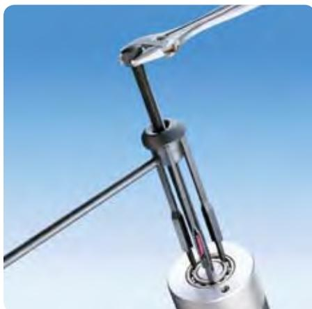
Использование ударного принципа позволяет прилагать к подшипнику большие усилия с целью его извлечения из отверстия корпуса.
